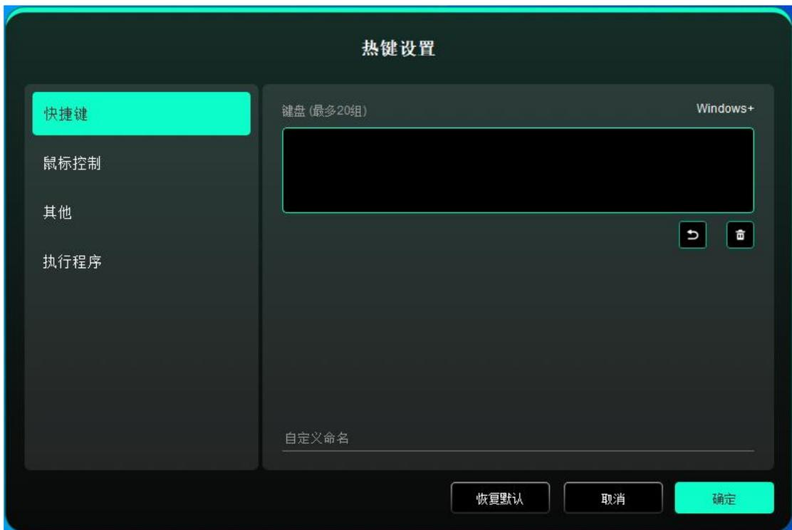
配置键盘快捷键，例如：在 3D MAX 软件中设置为“Alt+A”可以使用对齐工具。
